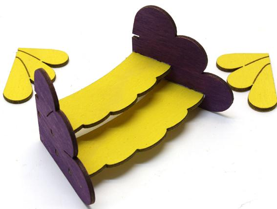
Auf beide Außenseiten gehören noch zwei Zierteile. Auch bei diesen zeigt die Gravur nach außen. Leimen Sie die Teile so auf, dass sie unten und hinten bündig mit dem größeren Geländeteil abschließen.
