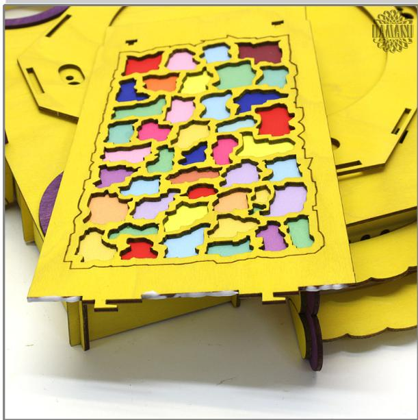
Nun wird das erste Seitenteil auf die Bodenplatte geleimt. Dazu wird nur auf die Stirnseite der Unterkante etwas Leim gegeben. Die Zapfen müssen völlig leimfrei sein.
