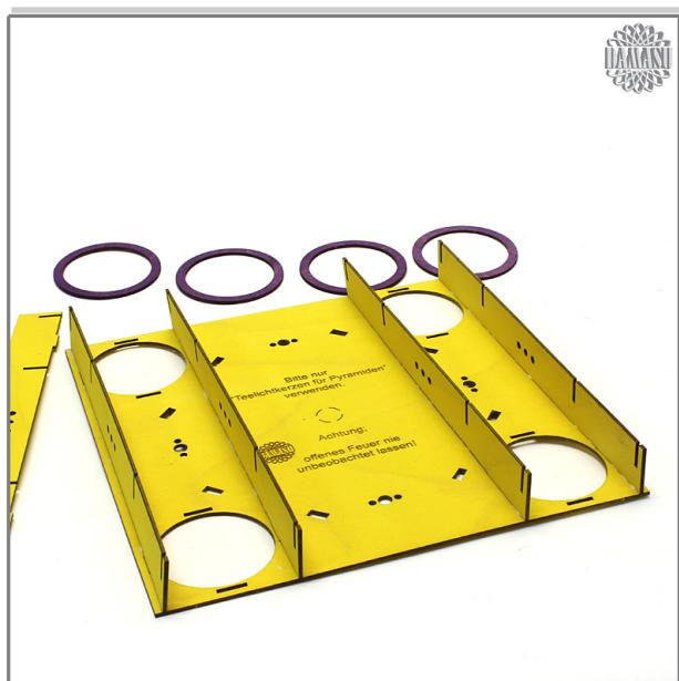
Es gibt zwei verschiedene Sorten von Leisten. Bei vier Leisten sind die Nuten und die Zapfen auf der gleichen Seite und bei vier Leisten sind die Nuten und die Zapfen auf der gegenüberliegenden Seite. Nehmen Sie die vier Leisten, bei denen sich die Nuten und die Zapfen gegenüberstehen und leimen Sie diese parallel in die Grundplatte ein. Achten Sie bitte auf die Beschriftung der Grundplatte. Diese zeigt in Richtung der Gitterstruktur.
