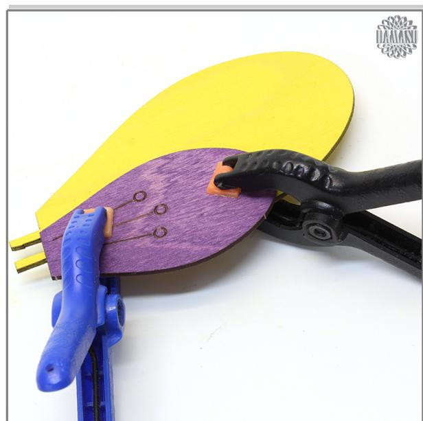
Die Flügel werden über der Verbindungsstelle einer Spante und dem größeren Zwischenring eingeleimt. Der Flügeldurchbruch zeigt dabei nach oben.
