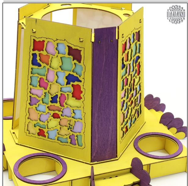
Setzen Sie die Seitenwand in die Nut der Bodenplatte ein und drücken Sie die Wand oben auf die Zapfen. Die obere Leimverbindung muss ganzflächig anliegen. Wenn das Sperrholz etwas krumm ist, dann müssen Sie die Leimverbindung andrücken bis sie hält.
