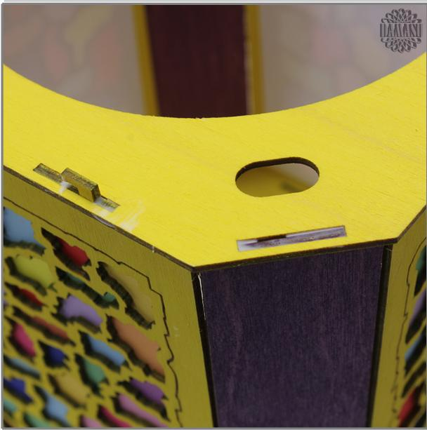
Wenn alles gut getrocknet ist, dann können Sie die untere Etage vorsichtig vom Sockel lösen. Drehen Sie die Etage um und streichen Sie alle Zapfenverbindungen von unten mit etwas Leim ein. Das gibt an dieser Stelle noch mehr Stabilität. Setzen Sie die Etage erst wieder auf den Sockel, wenn der Leim vollständig abgetrocknet ist.
