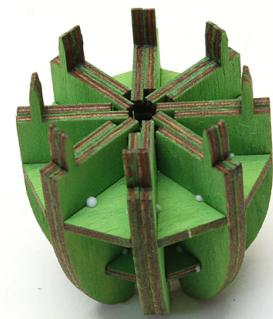
Von oben wird die Abdeckplatte aufgeleimt. Die kleinen Zapfen der Spanten sind der Anschlag für die Pyramidenachse. Ohne diese Zapfen könnte die Pyramidenachse die Abdeckplatte nach oben wegdrücken. Sollten Sie sich beim Zusammenleimen der Spanten etwas vertan haben, dann ist das nicht so schlimm. Entfernen Sie einfach die Zapfen, die nicht passen wollen. Für die Funktion müssen nicht alle acht Zapfen vorhanden sein.
